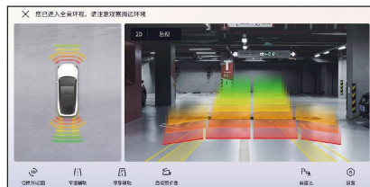
Interfaz de vista panorámica envolvente con alarma de 4 sensores de radar en la parte delantera y trasera.
