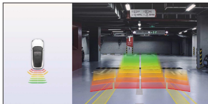
Interfaz de cámara de marcha atrás con alarma de 4 sensores de radar traseros.
